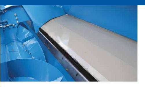
Модель шириной 12,8 метров имеет верхний капот и дефлектор колосьев, опирающиеся на главную заднюю балку.
